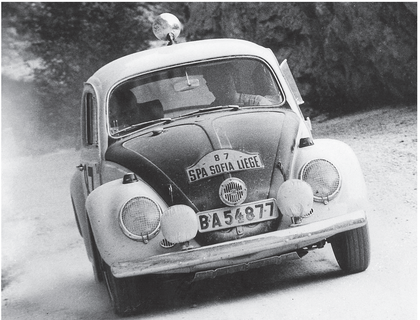
Rune "Ruppe" Larsson med kartläsare Börje Nilsson fotade under Spa-Sofia-Liege rallyt. Signalthornet behövdes då man passerade byarna. Notera också den utvändiga bensinpåfyllningen till 84 literstanken.
